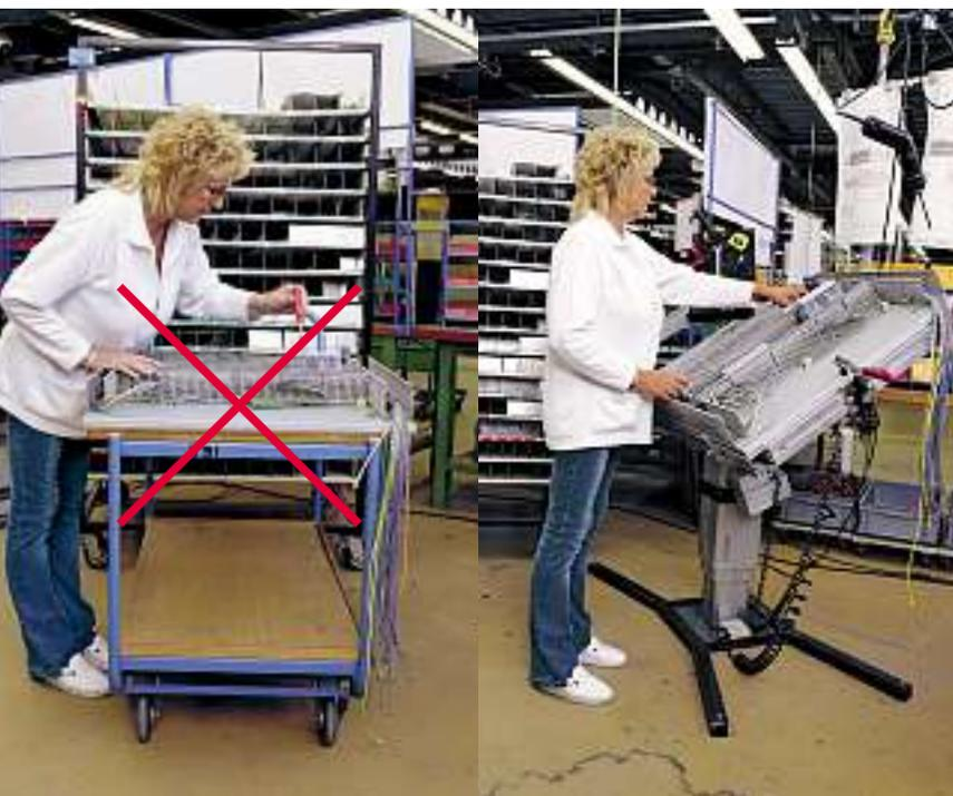
Fig. 6: Incliner de 30 degrés un récipient contenant des pièces en fonte (à droite) permet de réduire le temps de préhension et le couple de torsion subi par le dos. Avec pour résultat que ce dernier est moins sollicité et que le travail peut être accompli plus rapidement.
